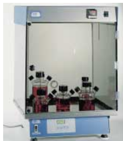
Agitateur magnétique "Celmag-L" installé dans la chambre d'incubation "Boxcult".
