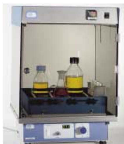
Agitateur orbital va-et-vient "Rotabit" installé dans la chambre d'incubation "Boxcult".
