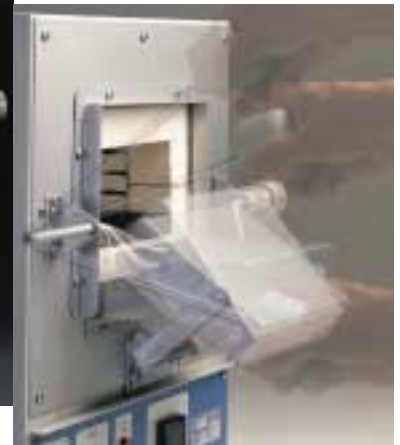
Détail du système d'ouverture basculante.
